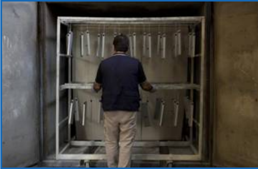
▲ Foto 8 - Fase di asciugatura pezzi
