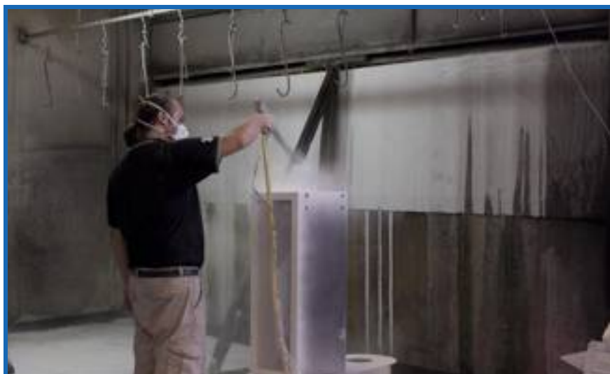
▲ Foto 7 - Fase di verniciatura a polvere
